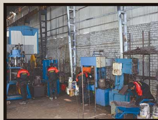
خمکاری بادستگاه های هیدرولیک
